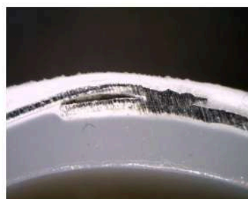
نمونه‌ای از جوش نامناسب بدلیل اینکه جوش در وسط دو لبه آلومینیوم صورت نگرفته است
